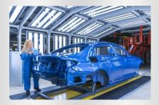
Nach einem Trockenvorgang entsteht so eine gleichmäßige, lückenlose Lackierung.
