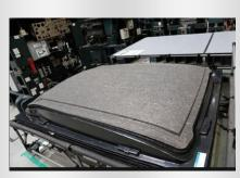
Im so genannten Preformprozess erhalten die bedarfsgerecht zugeschnittenen, jedoch noch flachen Gelege ihre dreidimensionale Kontur. Mehrere dieser vorgeformten Lagenpakete (Preform-Rohlinge) können später zu einem größeren Bauteil zusammengefügt werden. Dadurch lassen sich mit CFK beispielsweise hoch integrierte und großflächige Karosseriebauteile herstellen, die sich sonst nur mit großem Aufwand in Aluminium oder Stahlblech realisieren ließen.
