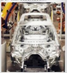
Der Karosseriebau ist der Fertigungsbereich mit dem höchsten Automatisierungsgrad.
